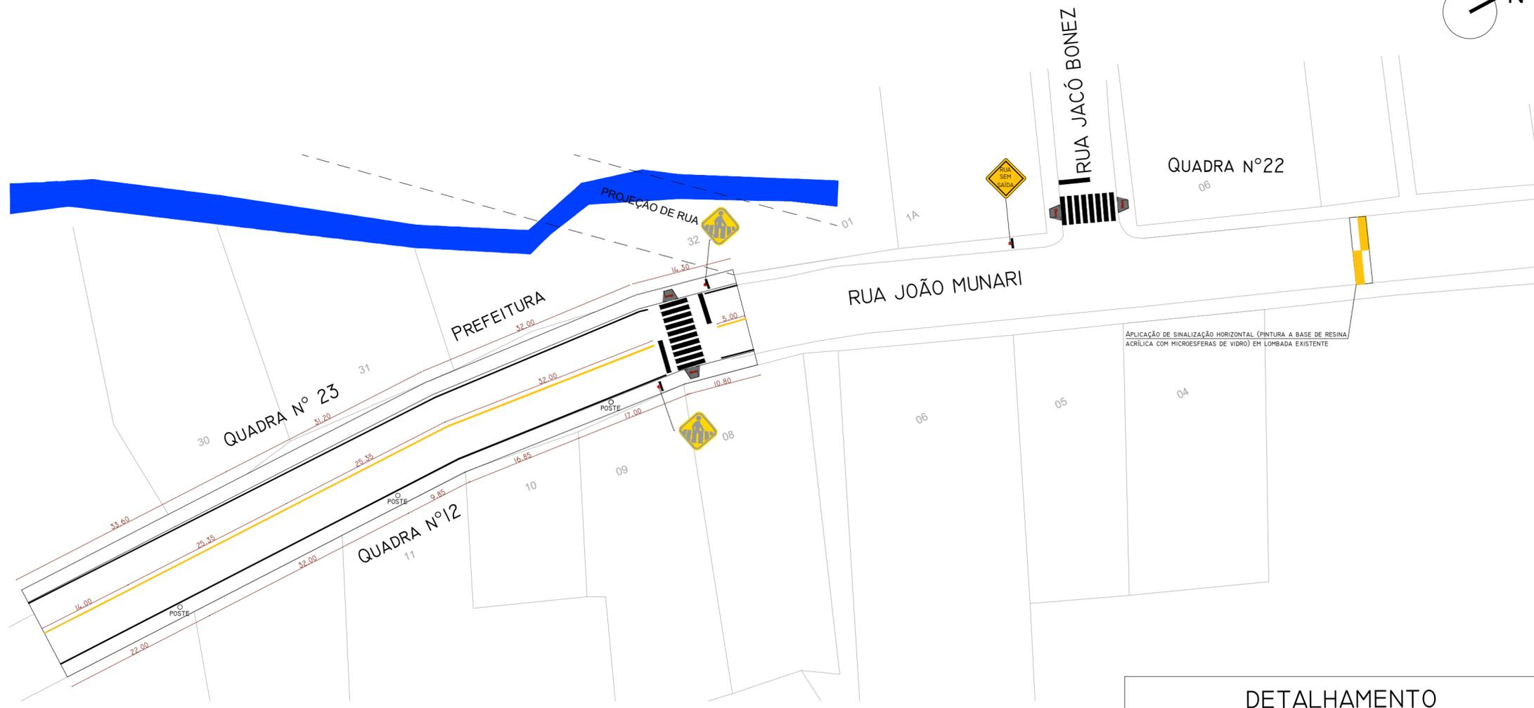
OBS: TODAS AS RAMPAS DE ACESSIBILIDADE E FAIXAS DE PEDESTRES, DEVERÃO ESTAR LOCALIZADAS APÓS AS BOCAS DE LOBO NO SEU SENTIDO DE ESCOAMENTO, DE FORMA QUE A ÁGUA SEJA COLETADA ANTES DA LOCALIZAÇÃO DOS DISPOSITIVOS DE ACESSIBILIDADE.
