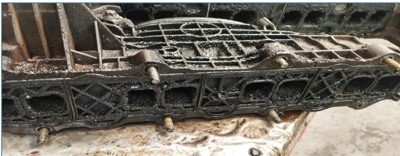
IMAGEM DETALHADA DO CATALISADOR DA VAN, TOTALMENTE IMUNDO, CARBONIZADO, COM MUITO ÓLEO
