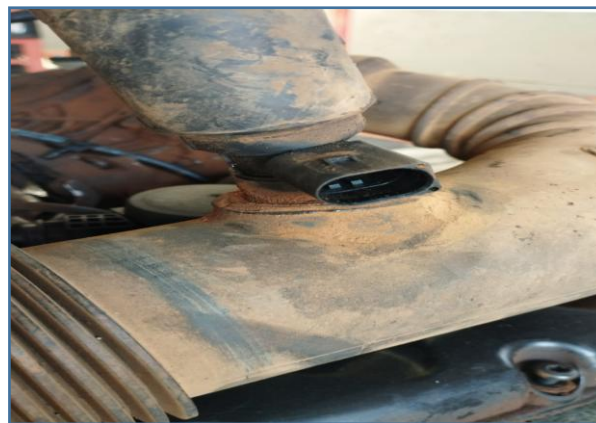
IMAGEM DO SENSOR DE TEMPERATURA DO MOTOR QUE APRESENTOU PROBLEMA
