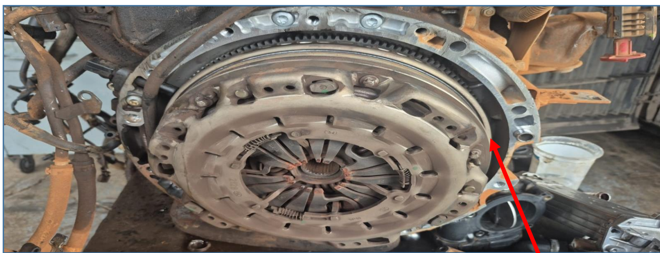
O CONJUNTO DUPLA MASSA DO SISTEMA DE EMBREAGEM ESTÁ DANIFICADO E NECESSITA SER SUBSTITUÍDO, APRESENTOU FOLGA EXCESSIVA NOS TESTES
