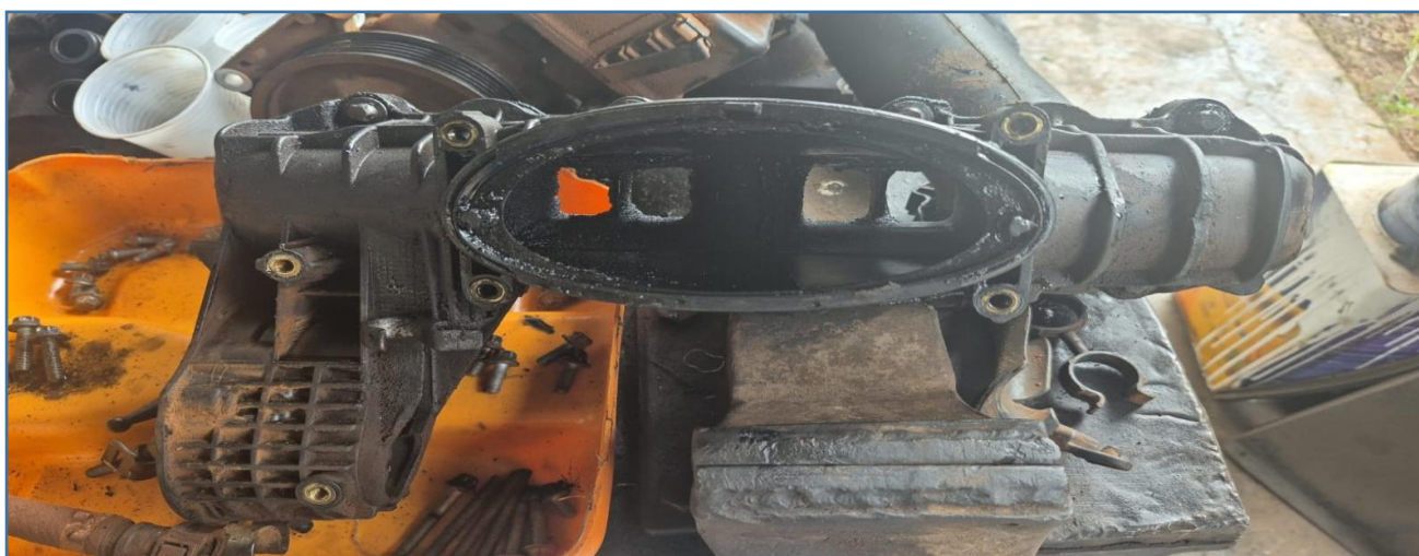
IMAGEM DA PARTE INVERTIDA DO CATALISADOR DA VAN, MUITO SUJO
