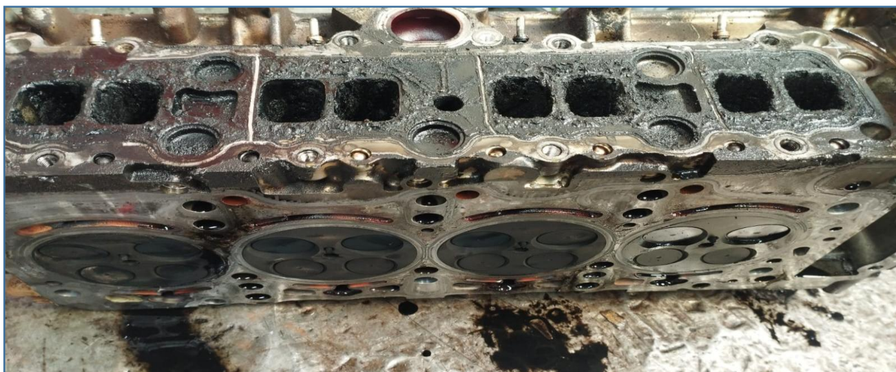
IMAGEM LADO "A" DO CABEÇOTE DO VEÍCULO QUE FOI DESMONTADO PARA VERIFICAÇÃO
