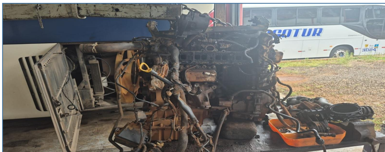
IMAGEM DO MOTOR DA VAN (MICRO-ÔNIBUS) MERCEDES BENZ JÁ RETIRADO DO VEÍCULO E COM ALGUNS COMPONENTES MECÂNICOS JÁ DESMONTADOS SOBRE A BANCADA
