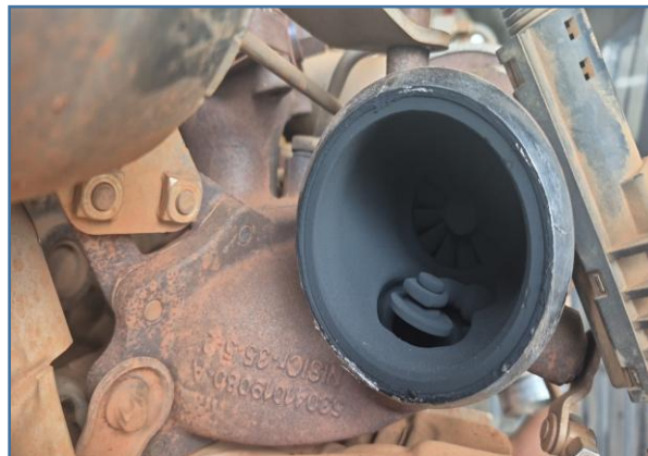
IMAGEM DETALHADA DA PARTE INTERNA DA TURBINA DA VAN
