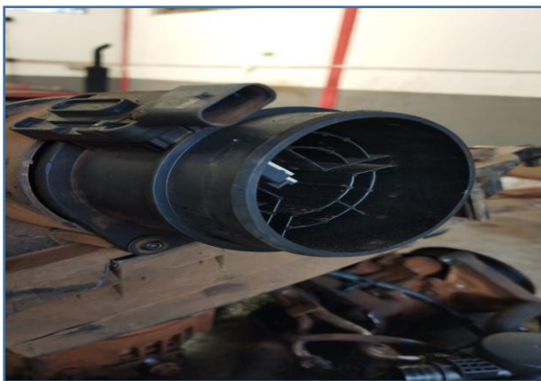
IMAGEM DO MAF, SENSOR DE FLUXO DE AR DO MOTOR QUE APRESENTOU PROBLEMA
